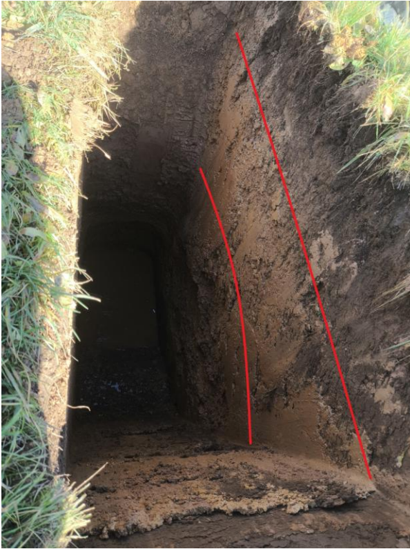
Slika 1: Razkop R1 z vrisano geol. mejo med sloji.
