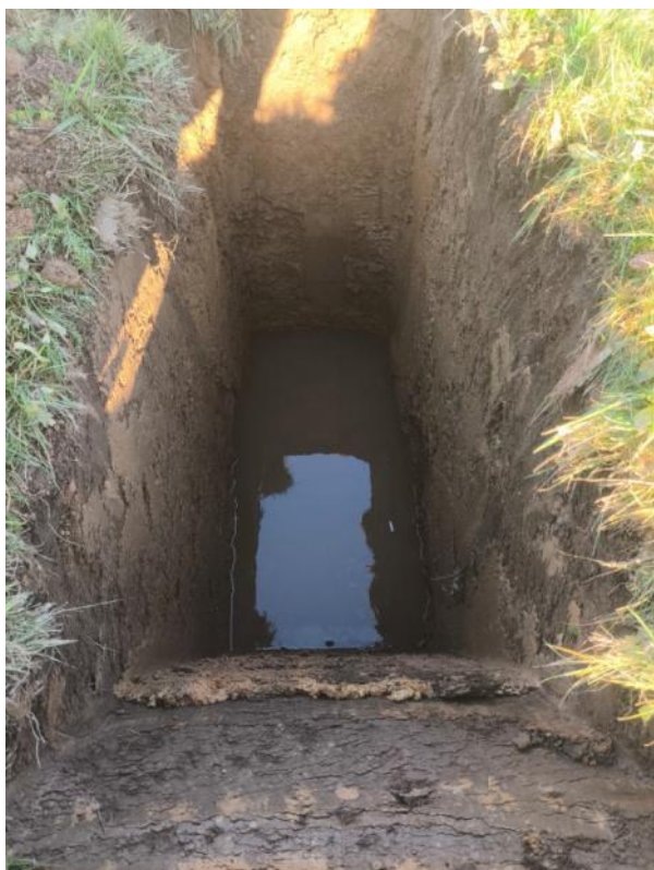
Slika 5: 1,1 m nabrane podzemne vode v R1.
